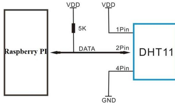
FIGURE 3. DHT11 circuit
